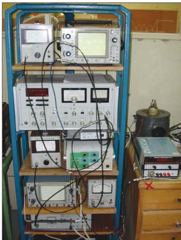
Рис. 1. Виброиспытательная система
